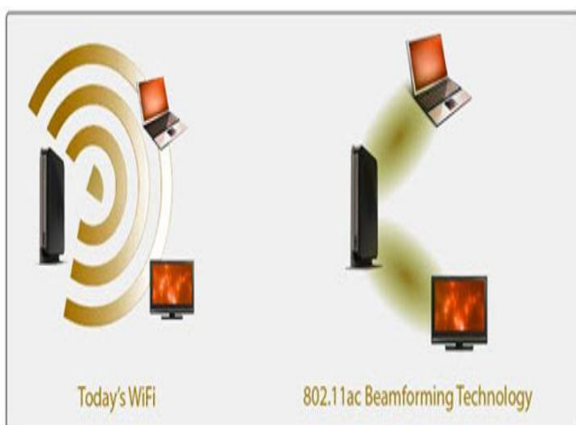
Figura 3. Beamforming - „Smart WiFi”
