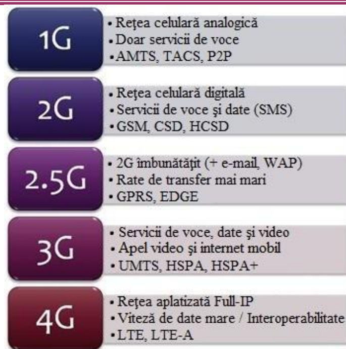
Fig. 3 Serviciile oferite de generațiile de rețele mobile
